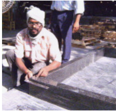
Die Prüfung der Maßgenauigkeit, z. B. von Einfassungen, ist bei GTP Routine.
